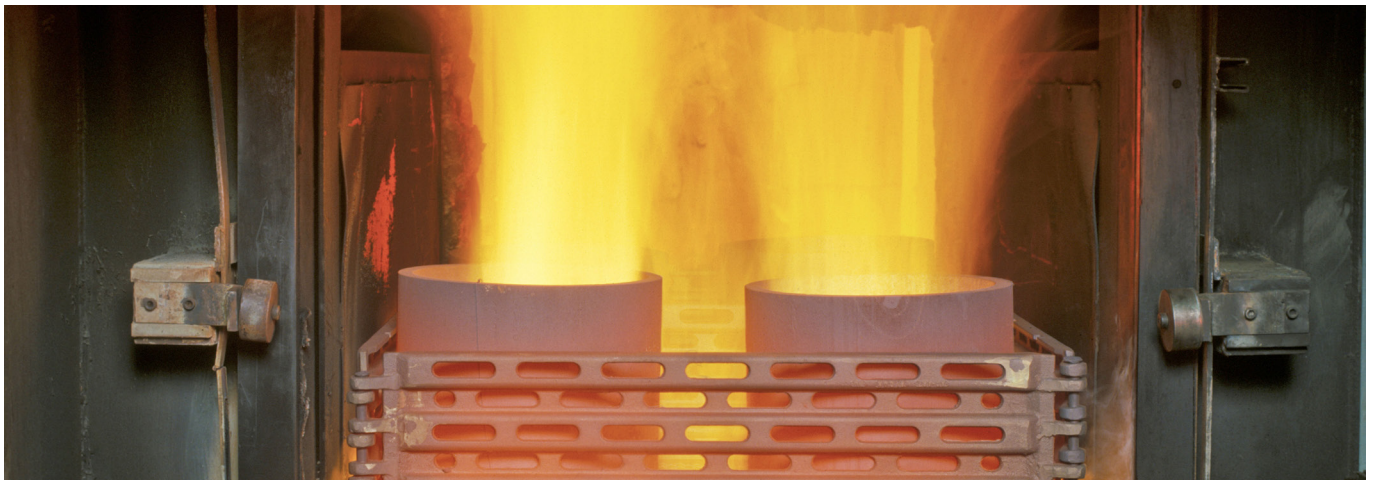
El proceso más empleado para el estabilizado de tensiones residuales de soldadura o laminación, el horno de gas.
